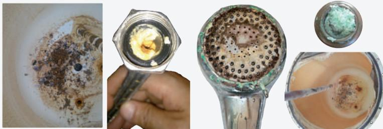
Le acque ricche di Calcio, evaporando per effetto della temperatura, provocano un progressivo accumulo di Carbonati di Calcio che si depositano sulle superfici di contatto.
